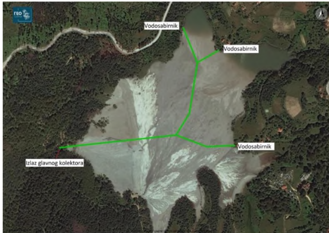
Slika 3. Šema položaja kolektora i vodosabirnika na jalovištu
